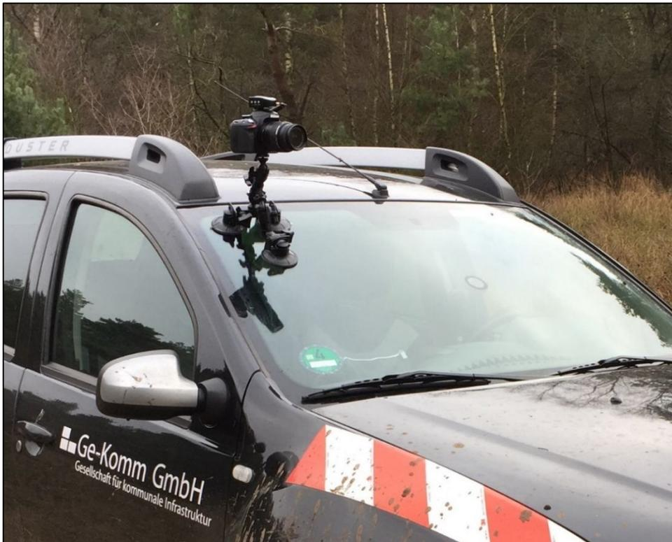
Abb.: Kamera mit GPS-Empfänger der Ge-Komm GmbH im Praxiseinsatz
